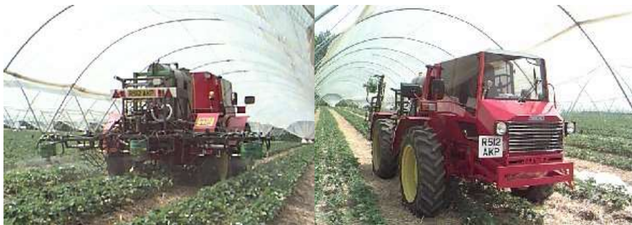
شکل ۲- سمپاش تونلی معمولی جگوار از نمای روبه‌رو و پشت‌سر.
