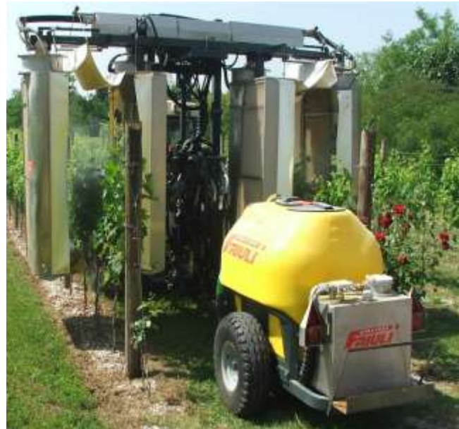
شکل ۶ - نمای یک سمپاش تونلی بازجذبی در حال سمپاشی درختچه های مو.
