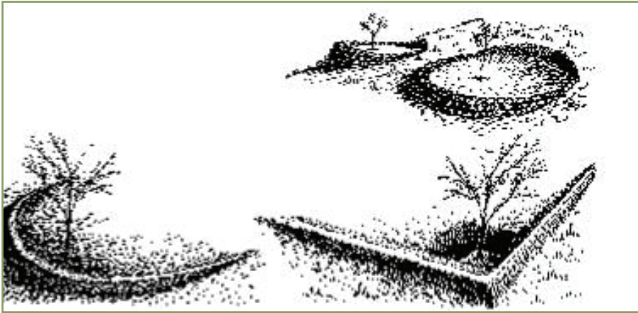
شکل ۳۲: سیستم جمع آوری آب در ریزحوضه‌ها
