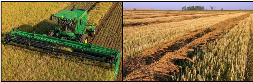
شکل ۹- بریدن و نوار کردن بوته‌های برداشت شده در مزرعه توسط ماشین درو-ردیف‌کن
