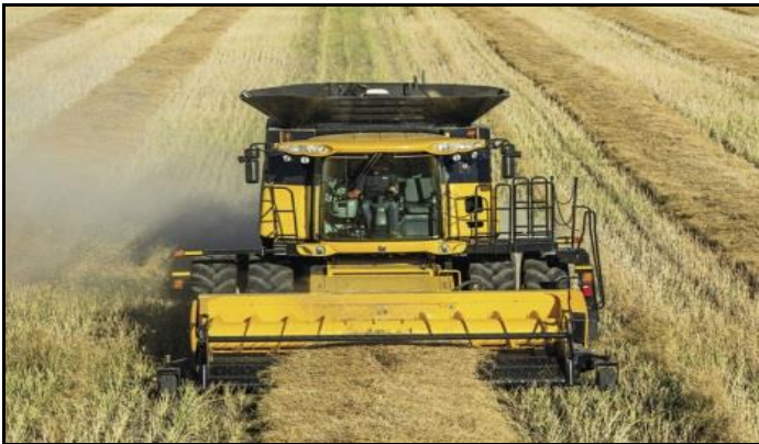
شکل ۱۰- برداشتن و خرمنکوبی محصول نوار شده توسط کمباین مجهز به هد بلندکننده
