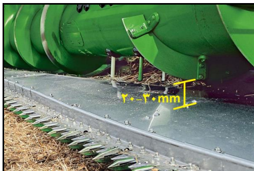
شکل ۱۵- فاصله هلیس (مارپیچ) تا کف سکوی برش کمباین
