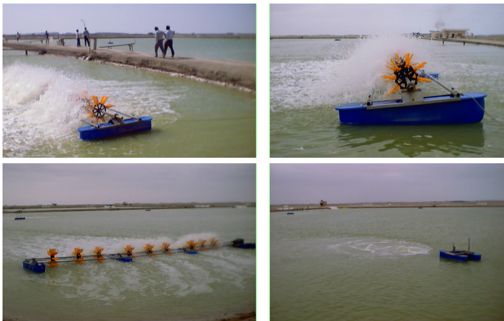
شکل ۵-۶- هوادهی با پدل ویل
