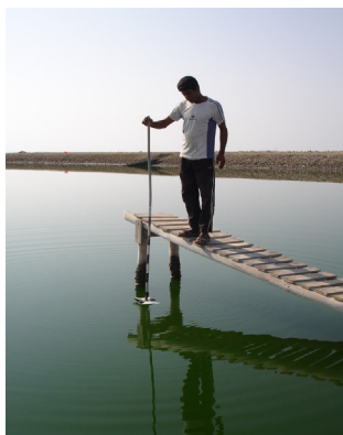
شکل ۵-۴- اندازه‌گیری عمق قابل رؤیت
