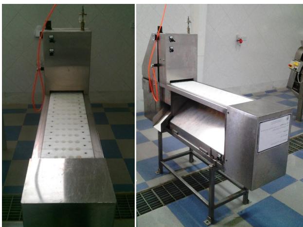
شکل ۱: نماهای روبرو و جانبی دستگاه هسته‌گیر سوزنی - فنجانی
