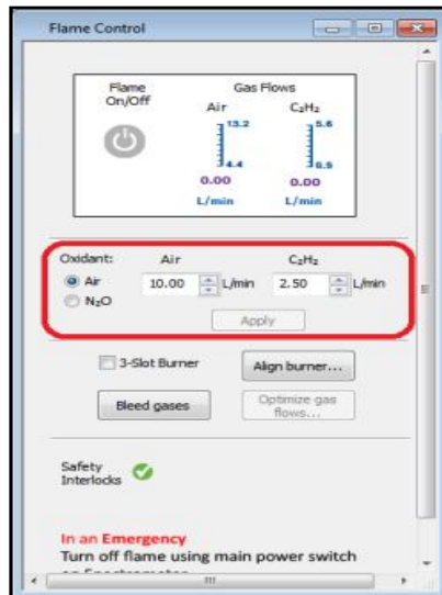
شکل 33- تنظیم نسبت اکسیدان به سوخت
