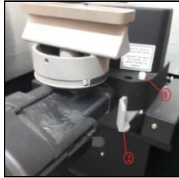
شکل 36- جدا کردن اتاقک مهپاش از دستگاه، (1) مهره سفید و (2) اهرم جداکننده
