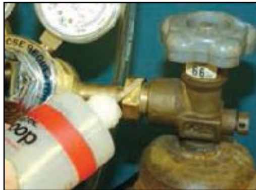
شکل 47- آزمودن نشتی بعد از بستن رگلاتور
