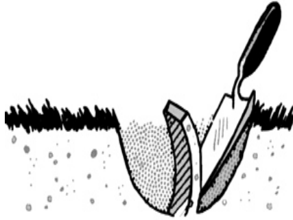
شکل 1-5. روش صحیح نمونه برداری با بیل
