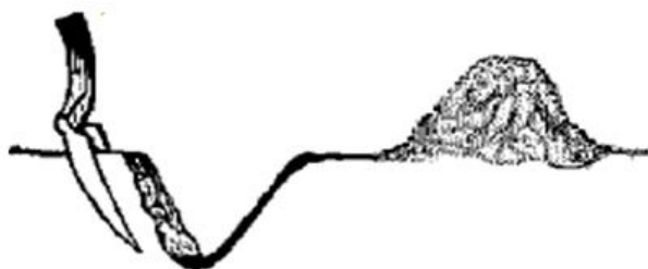
شکل 1-4. روش صحیح حفر خاک با بیل برای نمونه‌برداری
