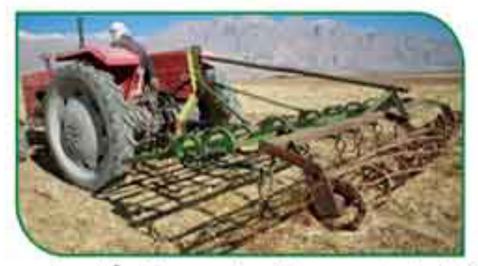
شکل ۴- استفاده از هرس دندان میخی به منظور آماده‌سازی بستر کاشت
