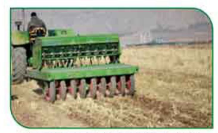
شکل ۵- استفاده از خطی کار غلات در کاشت نخود
