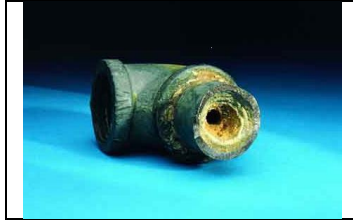
شکل ۲: آثار وجود سختی آب بر وسایل آب رسانی
