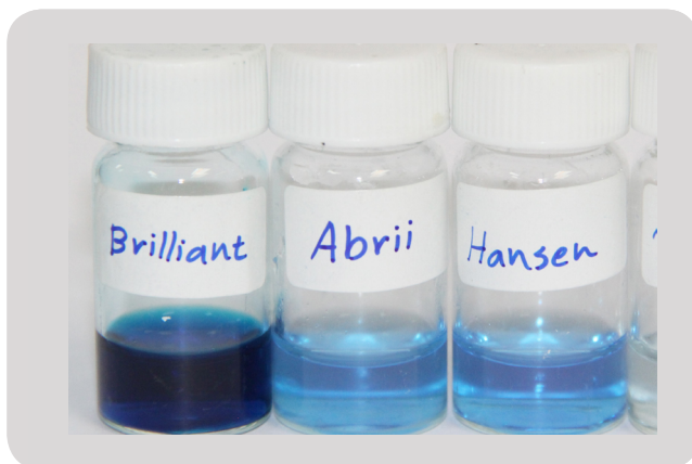
شکل ۵- مقایسه قدرت رنگ بریلیانت بلو (B)، فیکوسیانین استحصالی به روش پیشنهادی (ABRII) و نمونه خارجی از شرکت (Hansen).
