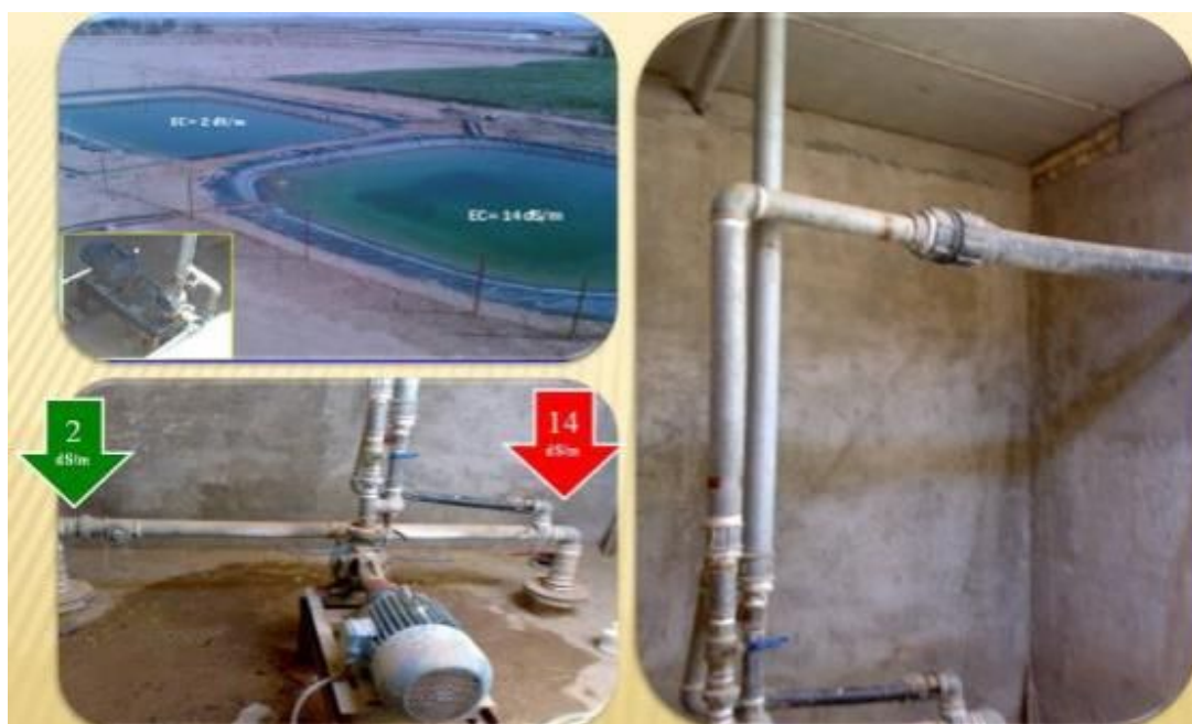
شکل ۱۲- نمایی از امکانات ایجاد شده به منظور تهیه دامنه‌ای از تیمارهای آب شور از آب غیر شور (۲ دسی‌زیمنس بر متر) تا آب بسیار شور (۱۴ دسی‌زیمنس بر متر) در مزرعه تحقیقاتی مرکز ملی تحقیقات شوری
