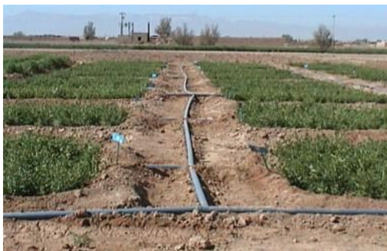
شکل ۱۳- نمایی از چگونگی توزیع آب شور در آزمایشات مزرعه ای تحقیقات شوری (رنجبر و اسماعیلی، ۱۳۸۴)
