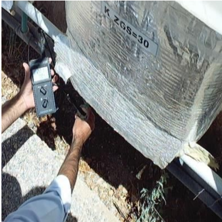
شکل ۸- کنترل EC آب زهکش در کشت در محیط ماسه نرم برای اطمینان از یکنواختی شوری در محیط ریشه
