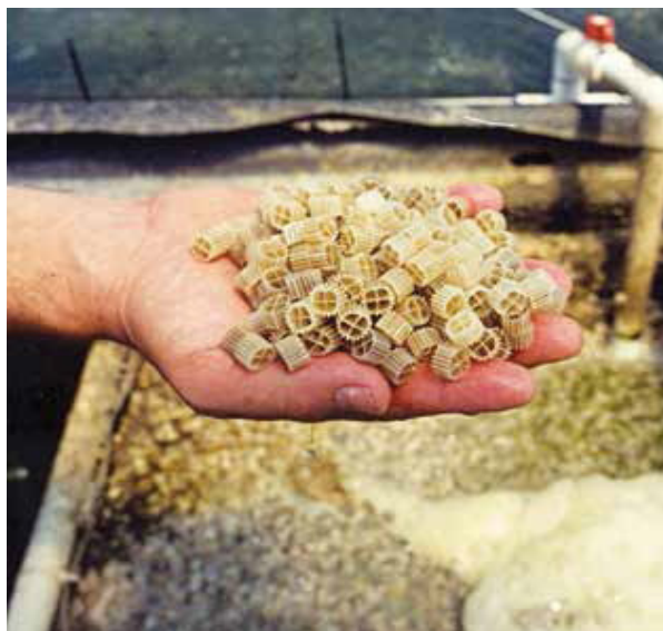
شکل ۳۸- مدیا (بستر بیوفیلتر) برای رشد باکتری در بیوفیلتر
