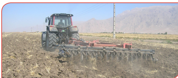
شکل ۳- عملیات دیسک‌زنی برای خردکردن کلوخ‌های مزرعه
