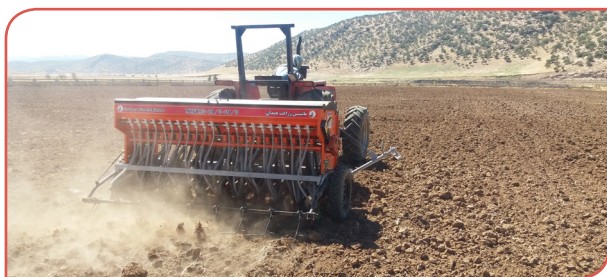
شکل ۱۵- بذرکار مخصوص کلزا (ساخت همدان)
