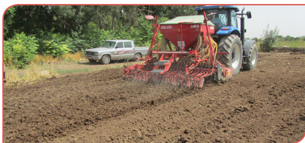
شکل ۱۴- بذرکار کمبینات یکی از بذرکارهای دقیق و مناسب برای کاشت کلزا است.
