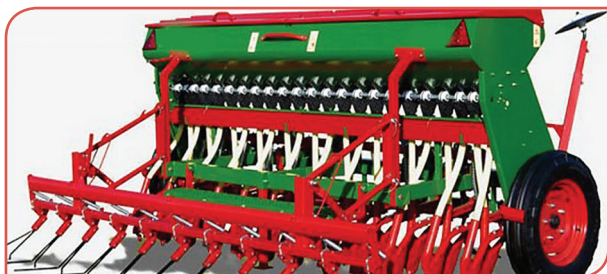
شکل ۱۳- کاشت با بذرکارهای غلات (بذرکار ردیفی همدانی) بدون بستن لوله‌های سقوط بذر گندم امکان‌پذیر است.
