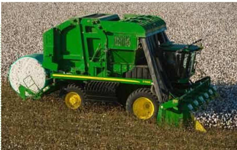
شکل ۱- کمباین وش چین مجهز به سیستم بسته بندی وش
