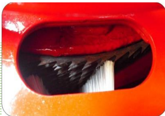
شکل ۶- برس‌های دوار یا استوانه پنبه‌گیر
