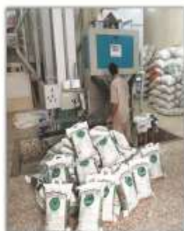
دستگاه سورتینگ جهت جداسازی تکمیلی شپشه و لارو از دانه های برنج
