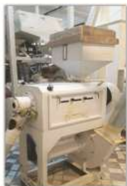
دستگاه پولیش برای جداسازی تخم، لارو و حشره کامل از برنج
