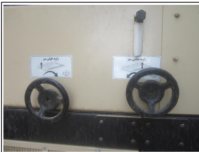
شکل ۱۲- نمونه ایی از اهرم‌های تغییر زاویه صفحه در میز گراویتی (بی نام، ۱۳۹۵)
