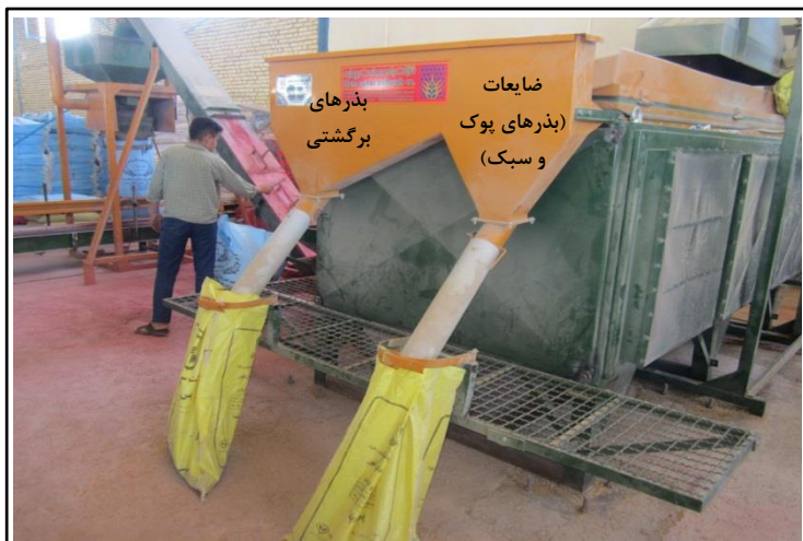
شکل ۱۷- خروجی ضایعات برگشتی در میز گراویتی (تصویر از نگارنده)
