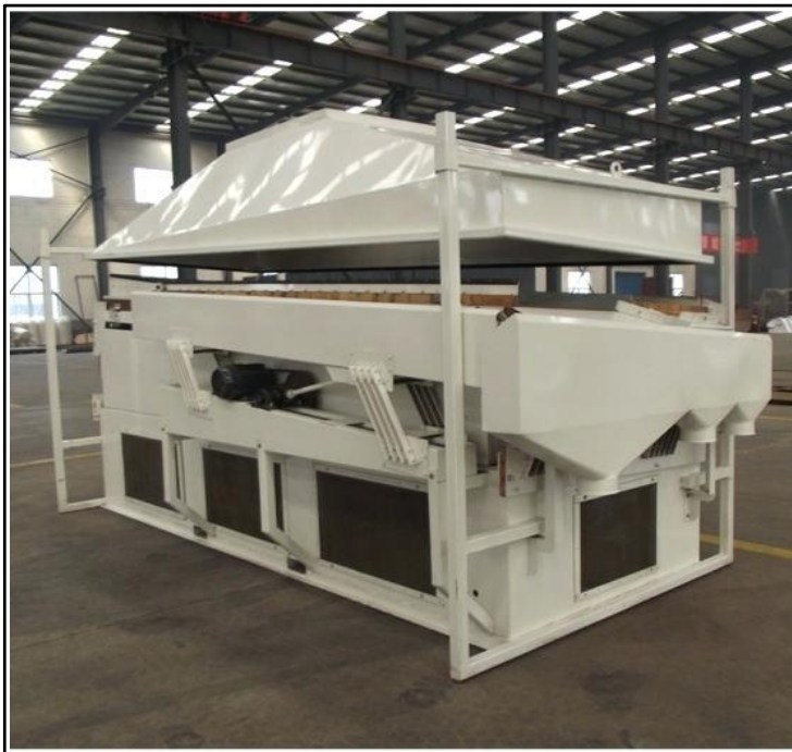
شکل ۱۰- میز گراویتی مجهز به هود (تصویر از نگارنده)
