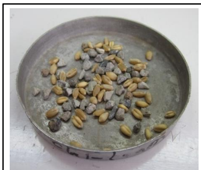
شکل ۱۶- ضایعات سنگریزه به همراه بذرهای خیلی درشت گندم (تصویر از نگارنده)
