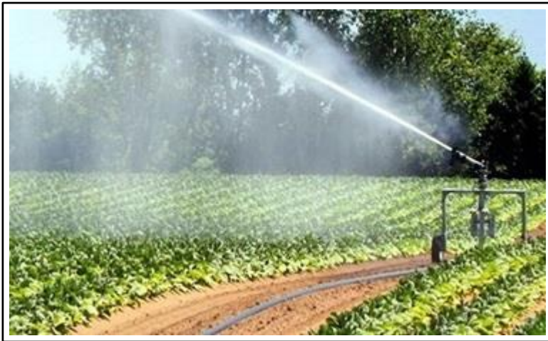
شکل ۴- نمونه‌ای از ارابه همراه با آبیاش تفنگی در حال آبیاری
