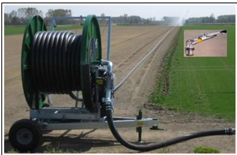
شکل ۵- ماشین آبیاری قرقره‌ای، ارابه و آبیاش تفنگی در حال کار
