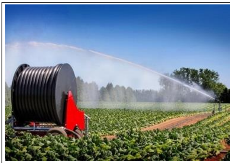
شکل ۳- ماشین آبیاری آبفشان قرقره‌ای در حال آبیاری با آبپاش تفنگی
