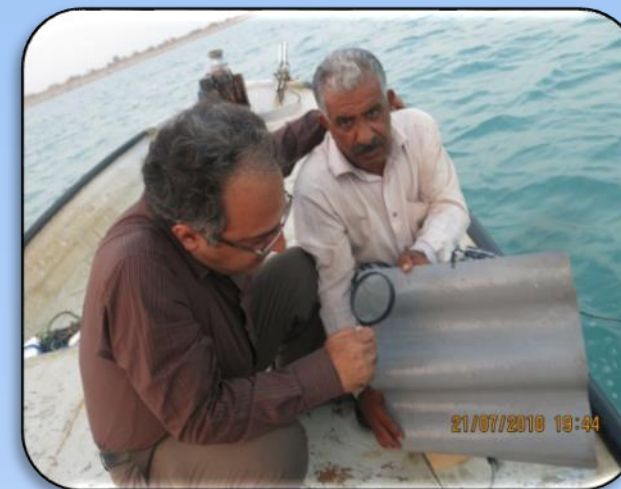
۴) بررسی میزان نشست صدفچه با ذره بین معمولی
