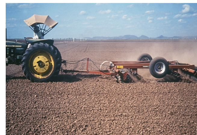
شکل ۱) نمایی از نحوه تسطیح مزرعه گندم
