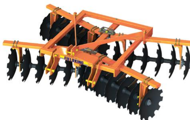
شکل ۳- دیسک دو زانوئی یا چهار دسته‌ای (تاندوم) با بشقاب‌های لبه کنگره‌ای
