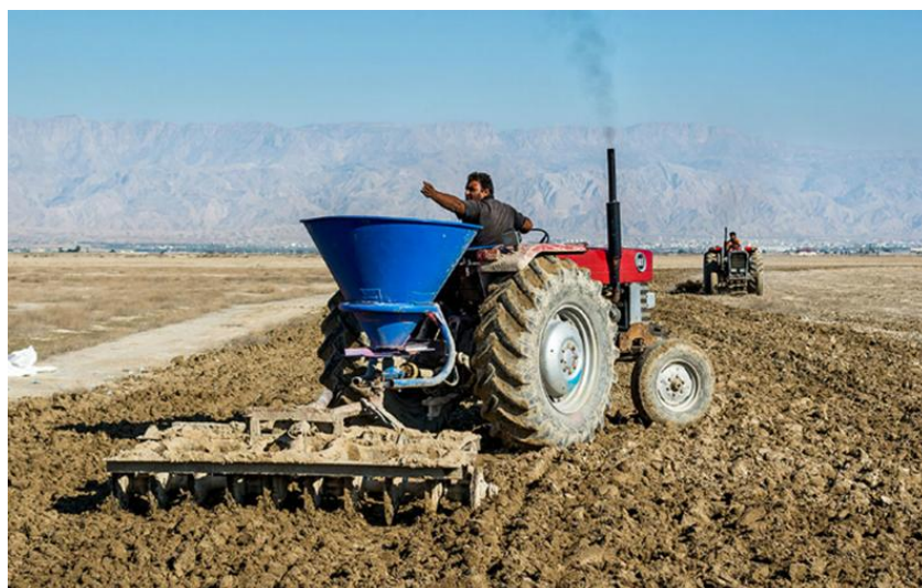
شکل ۸- به زیر خاک بردن بذر به وسیله دیسک
