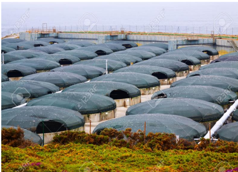
تصویر ۱۱: استفاده از سایه بان جداگانه بر روی هر حوضچه برای جلوگیری از تاثیر نور بر ماهیان
