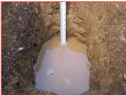
شکل ۲۰- زهکشی خاک در صحرا: حفر حفره‌ای در خاک (بالا)، پیش مرطوب سازی حفره (وسط)، برآورد سرعت فرونشست آب (پایین)
