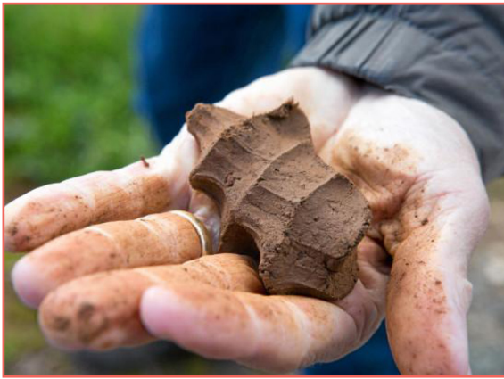
شکل ۱۹- آزمایش تعیین بافت خاک: خاک رسی
