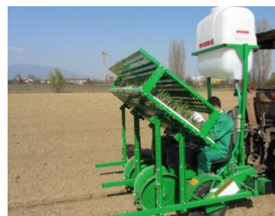
شکل ۲-۶- دستگاه نشاکار نیمه اتوماتیک جهت کاشت نشاء پیاز به صورت ۵ نفره و ۲ نفره
