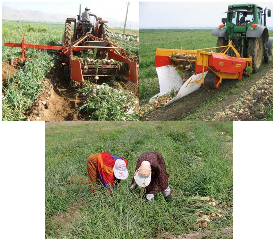
شکل ۸-۶- برداشت پیاز به روش مکانیزه با استفاده از ماشین مجهز به ردیفکن (بالا سمت راست) و بدون ردیفکن (بالا سمت چپ) و برداشت دستی پیاز (پایین)
