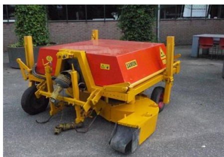
شکل ۸-۳- دستگاه سرزنی پیاز (سمت چپ)، تیغه‌های دوار زیر دستگاه با امکان تنظیم ارتفاع (سمت راست)
