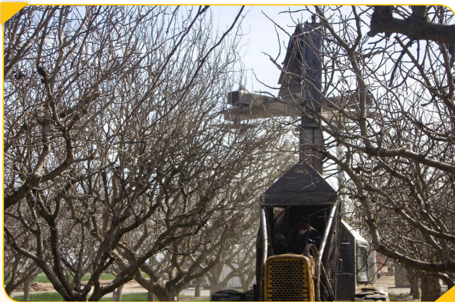
شکل ۶- هرس زمستانه با استفاده از ماشین‌های پیشرفته که عملیات هرس حاشیه زنی را انجام می‌دهد
