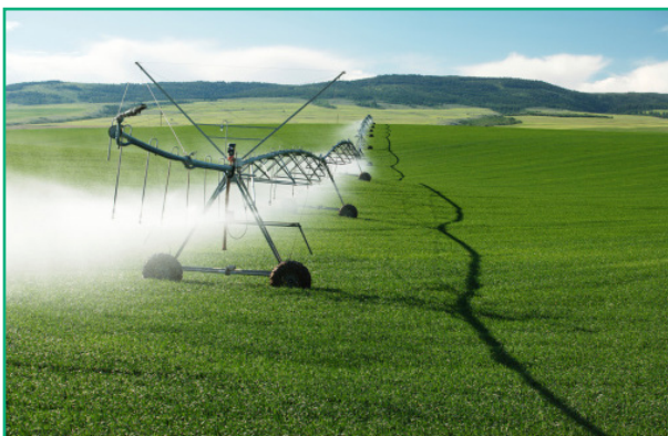
شکل ۵- نمایی از یک سامانه آبیاری بارانی متحرک پیوسته با حرکت دوار (آبفشان عقربه‌ای)
