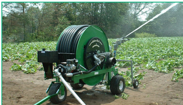
شکل ۶- نمونه‌هایی از یک سامانه آبیاری بارانی متحرک پیوسته با یک آب‌پاش (آب‌فشان قرقره‌ای)
