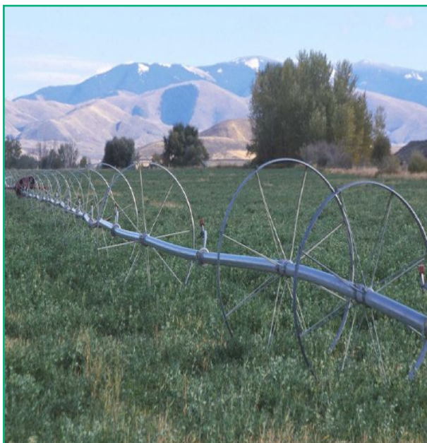
شکل ۴- نمایی از یک سامانه آبیاری بارانی ساکن (متحرک دوره‌ای با جابه‌جایی مکانیکی (آب‌فشان غلطان))
