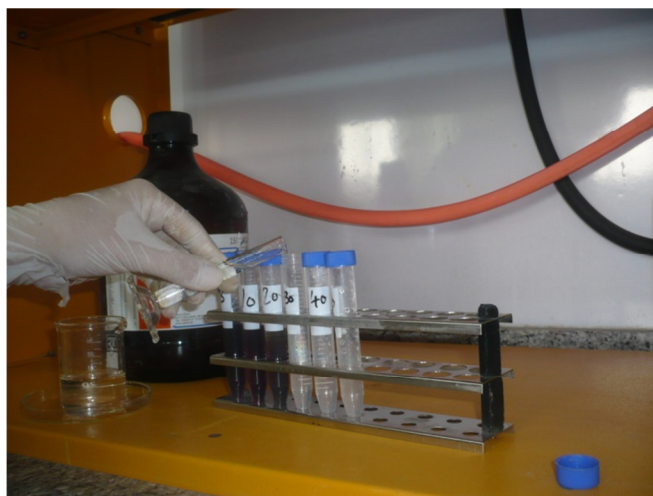
شکل ۸: اندازه‌گیری کربوهیدرات محلول در مرحله استقرار چغندر به روش فنل اسید سولفوریک
