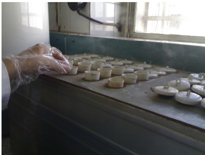
شکل ۹: هضم تر نمونه چغندر با اسید کلریدریک جهت اندازه‌گیری سدیم و پتاسیم به روش نشر شعله
