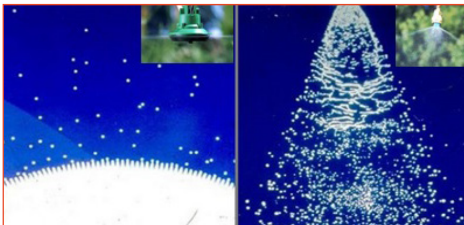
شکل ۳- تشکیل قطرات پاشش در نازل‌های هیدرولیک (سمت راست) و نازل میکرونر (سمت چپ)
