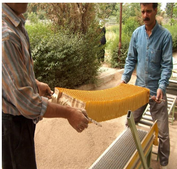
شکل ۳- نحوه قرار دادن کاغذ گلدان روی پایه دستگاه
