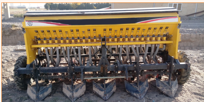
شکل ۵- خطی کار کف کار با ۵ فاروئر در عرض کار ۳ متر
