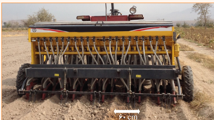
شکل ۶- کشت در داخل جویچه‌های ۶۰ سانتی‌متری با کف کار پنج فاروئر
