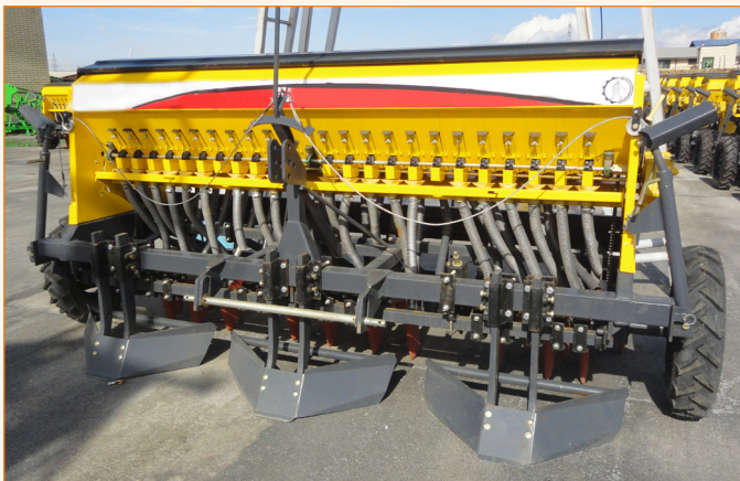
شکل ۳- خطی کار کف‌کار با سه فاروئر در عرض کار ۳ متر
