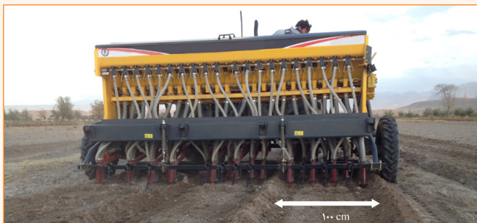
شکل ۴- کشت در داخل جویچه‌های به عرض ۱۰۰ سانتی‌متر با کف کار سه فاروئر
