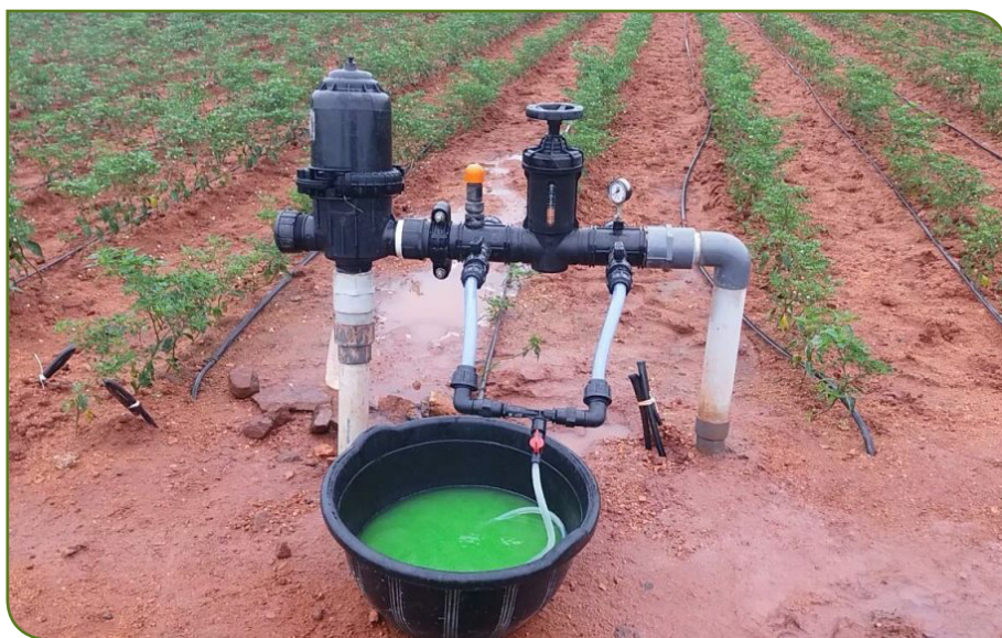
شکل ۸- تزریق ماده شیمیایی به روش ونتوری در سیستم آبیاری قطره‌ای
