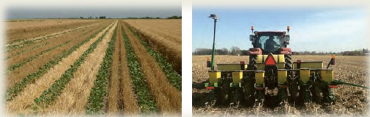
شکل ۲- استفاده از ردیفکار جهت کاشت سویا به روش بدون شخم
