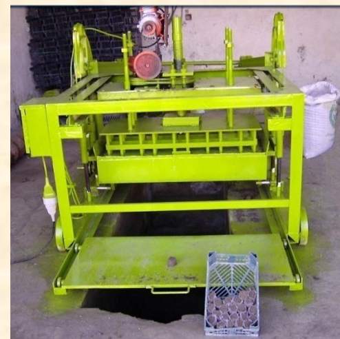
شکل ۱: دستگاه گلدان ساز از نمای مقابل.
