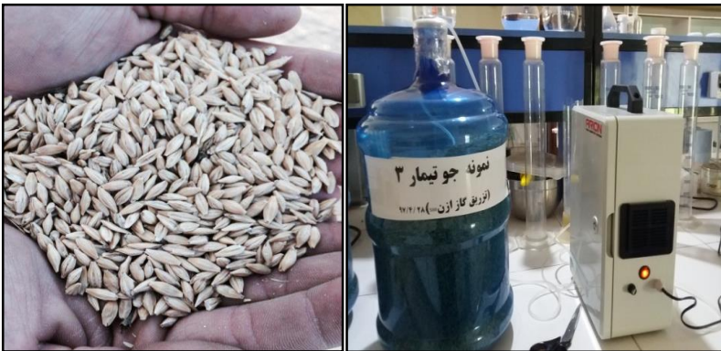
شکل ۷- ازن‌دهی دانه جو و حفظ کیفیت دانه در شرایط بهینه (آزمایشگاهی)
