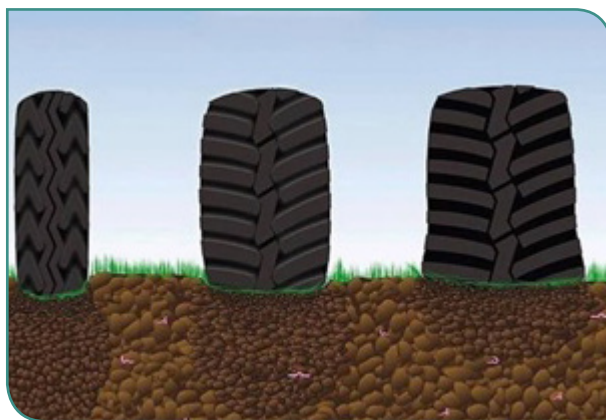
شکل ۷- اثر سطح تماس چرخهای ماشین آلات کشاورزی بر میزان تراکم خاک
