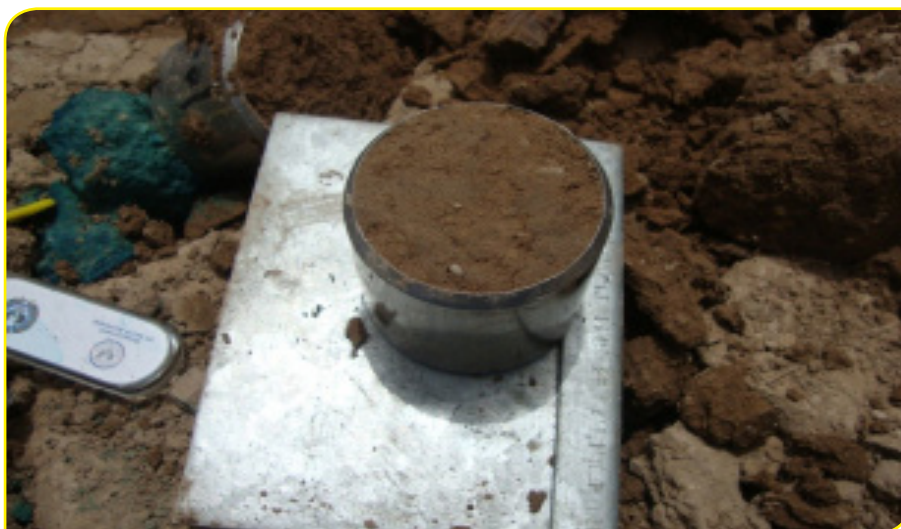
شکل ۳- نحوه نمونه برداری خاک دست نخورده به منظور تعیین جرم مخصوص ظاهری
