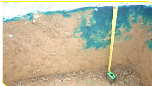
شکل ۸- روش نفوذ ماده ردیاب رنگی به منظور ارزیابی تراکم
