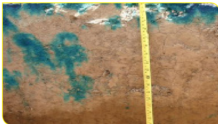
شکل ۱۰- تصویر نفوذ ماده ردیاب رنگی در خاک
