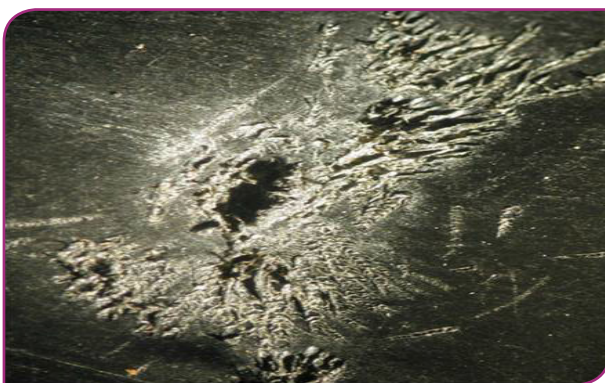
شکل ۳۰- نمونه‌هایی از آسیب‌های وارد شده به لوله‌ها توسط حشرات و حیوانات
