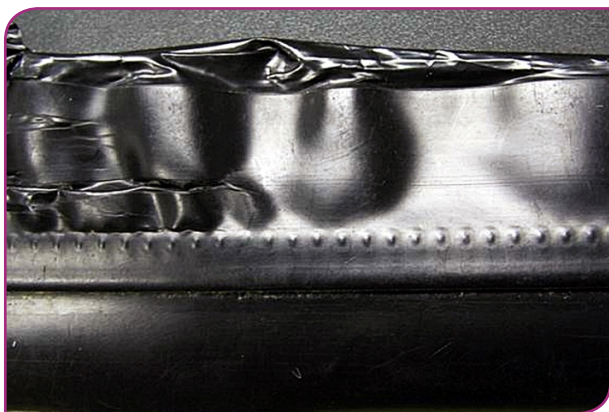
شکل ۴۷- نمونه‌ای از آسیب وارد شده به نوار تیپ بر اثر فشار بالا در نوار
