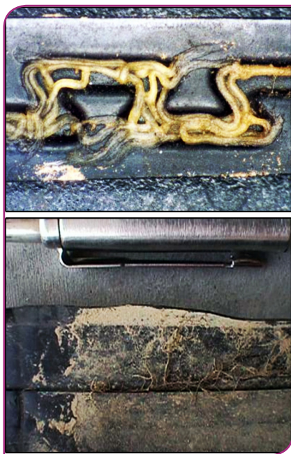
شکل ۴۴- نمونه نفوذ ریشه به داخل نوار تیپ
