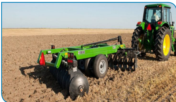
شکل ۳۵- استفاده از دیسک برای اختلاط کود با خاک
