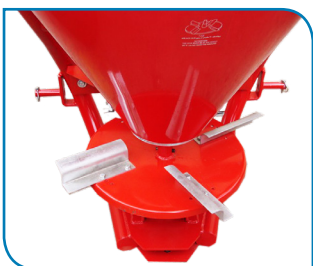
شکل ۱۶- بذrpاش و دیسک جهت خاک کردن بذر
