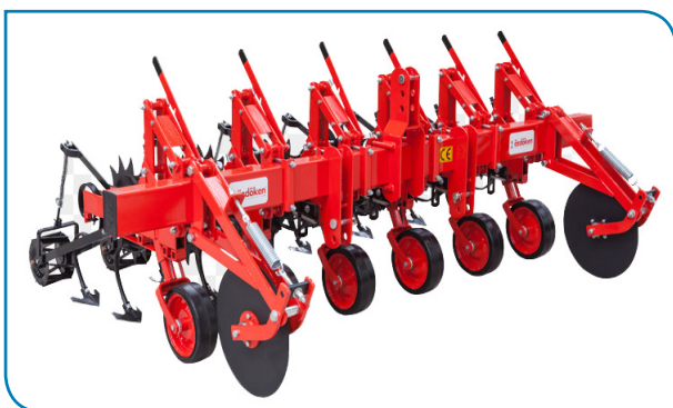
شکل ۲۴- کولتیواتور ردیفی با تیغه‌های پنجه‌غازی
