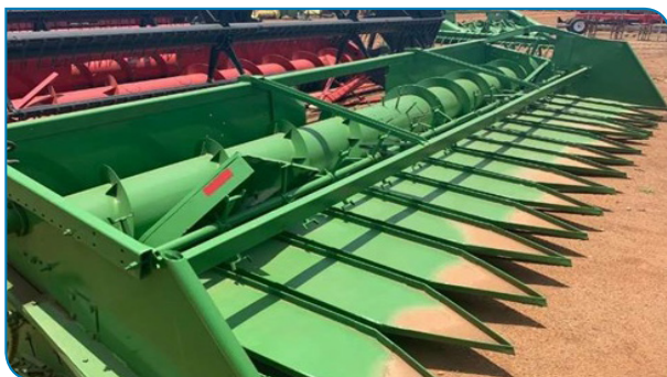
شکل ۴۲- هد مخصوص برداشت آفتابگردان
