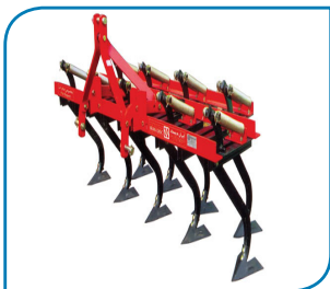
شکل ۱۲- خاک‌ورزهای مرکب متشکل از تیغه‌های پنجه‌غازی، قلمی و غلتک
