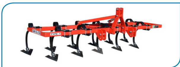
شکل ۱۱- گاواهن قلمی مناسب برای کم‌خاک‌ورزی در اراضی دیم
