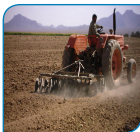
شکل ۱۶- بذrpاش و دیسک جهت خاک کردن بذر
