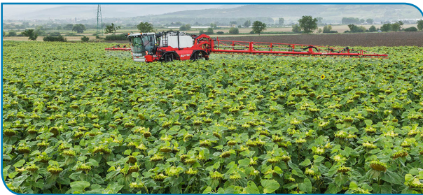
شکل ۳۱- سمپاش بومدار پشت تراکتوری در حال سمپاشی
