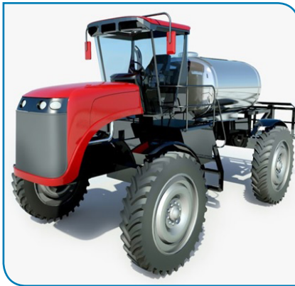
شکل ۳۷- استفاده از سم‌پاش چرخ باریک در عملیات داشت
