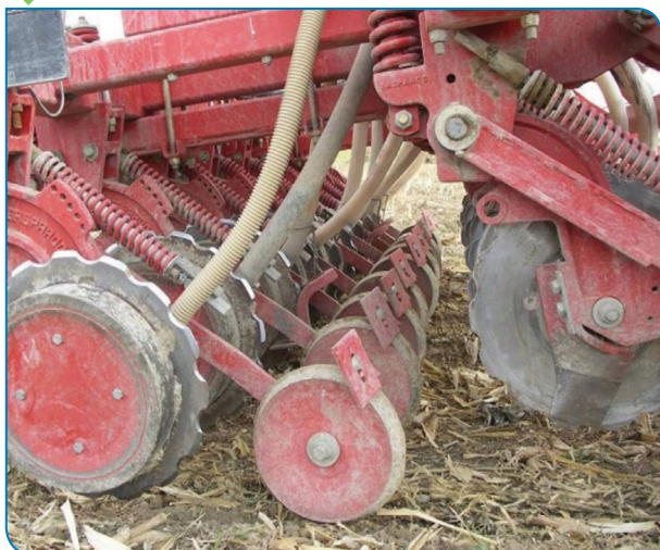
شکل ۱۵- خطی کار کاشت مستقیم با شیار بازکن دیسکی کنگره‌ای
