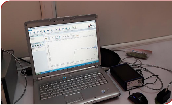
شکل ۸- تشخیص بیماری آتشک با استفاده از دستگاه طیف‌سنج
