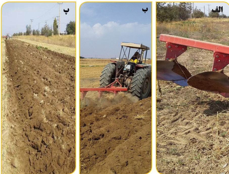
شکل ۱- گاوآهن برگرداندار (الف) - گاوآهن برگرداندار ب- شخم با گاوآهن برگرداندار پ- وضعیت سطح خاک بعد از شخم)
