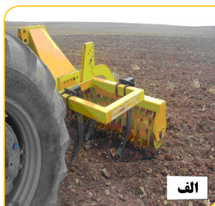
شکل ۹- خاک‌ورز مرکب حفاظتی (الف- گاواهن قلمی با تیغه‌های قلمی مجهز به غلطک) و (ب- گاواهن قلمی با تیغه‌های پنجه‌غازی مجهز به غلطک)
