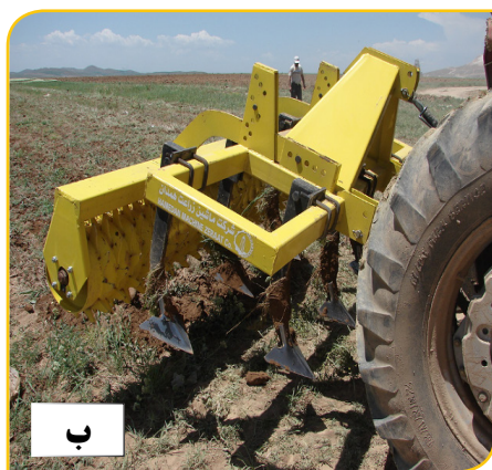
شکل ۹- خاک‌ورز مرکب حفاظتی (الف- گاواهن قلمی با تیغه‌های قلمی مجهز به غلطک) و (ب- گاواهن قلمی با تیغه‌های پنجه‌غازی مجهز به غلطک)
