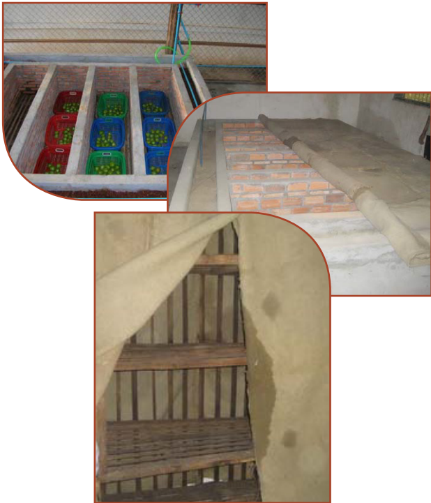
شکل ۱۸- خنک‌کننده تبخیری در دو نوع دیواره آجری-سیمانی و طبقه‌بندی چوبی (بالا به پایین)
