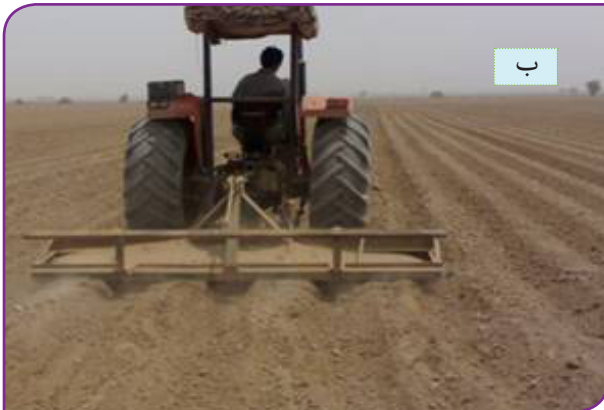
شکل ۵ - الف) فاروئر با باله‌های پهن و فاصله ردیف‌های ۷۵ سانتی‌متری ب) استفاده از شیپر برای دوزنقه‌ای کردن سطح و دیواره فاروئرها
