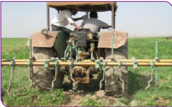
شکل ۳۷- سله شکنی خاک با استفاده از کولتیواتور غلتان
