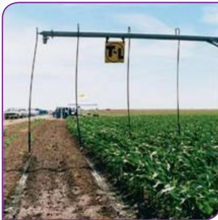
شکل ۲۶- آبیاری مزرعه ذرت با استفاده از آبپاش لپا به روش شیاری
