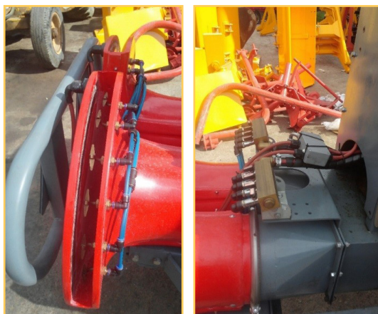
شکل ۲۰- تجهیزات افزوده شده به سم پاش توربینی برای باردار کردن ذرات محلول سم
