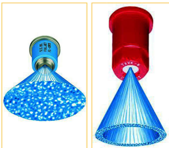
شکل ۲۵- نازل مخروطی با الگوی پاشش توخالی (سمت راست) و تو پر (سمت چپ)
