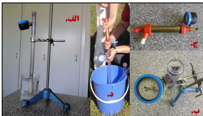
شکل ۸- آماده سازی تانسیومتر قبل از نصب: الف- اشباع کلاhek سرامیکی، ب- نمای از بالا، ج - پمپ خلاء دستی، د- هواگیری تانسیومتر و واسنجی خلاءسنج.
