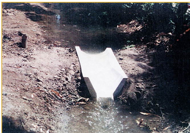
شکل ۸- نمونه‌ای از WSC فلوم کارگذاری شده در مسیر نهر طبیعی
