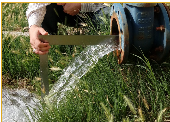
شکل ۹- اندازه‌گیری به روش جت جریان در لوله افقی
