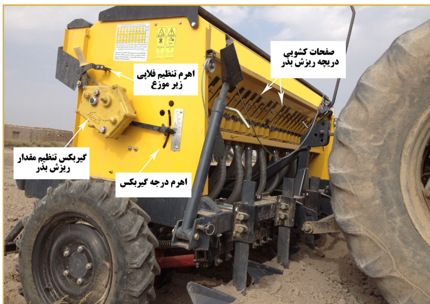
شکل ۵- اجزای خطی کار غلات برای تنظیم میزان بذر و کود مصرفی (کالیبراسیون)
