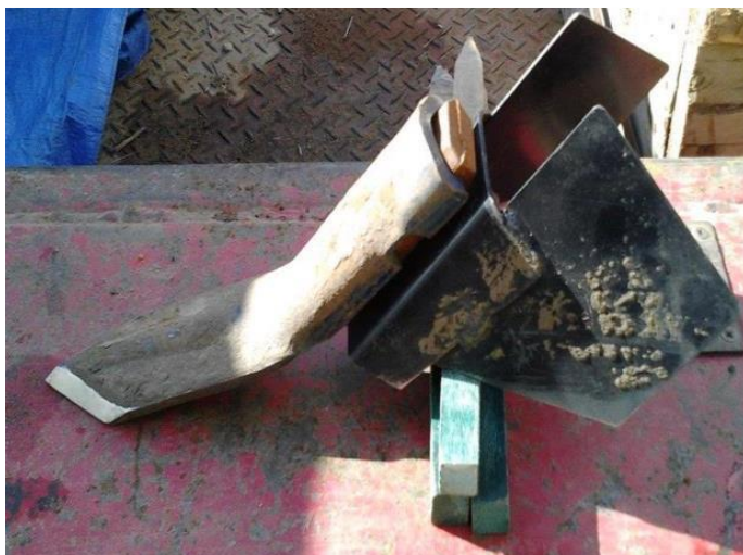
شکل ۵- استقرار یک بخش جارو مانند در جلوی یک دیسک کارنده (برگرفته از Simpfendorfer et al., 2019).
