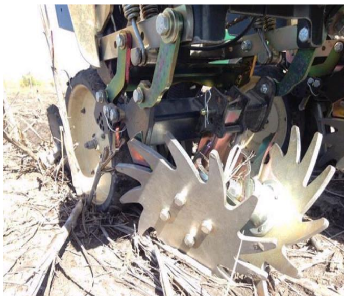
شکل ۶- برداشتن کلس غلات از ردیف کاشت به کمک یک پاک‌کننده ردیفی در جلوی یک دیسک کارنده (برگرفته از Simpfendorfer et al. , 2019).
