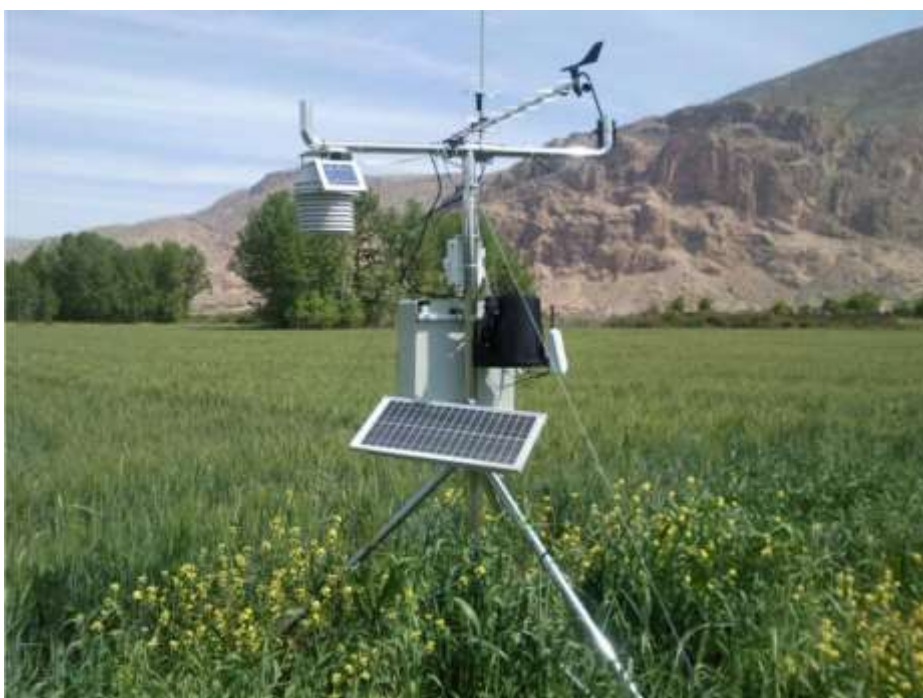
شکل ۱: دیتالاگر برای ثبت از راه دور لحظه فاکتورهای هواشناسی
