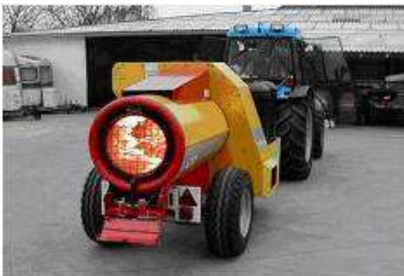
شکل ۴: بخاری متحرک باغی که توسط تراکتور جابجا می‌شود.
