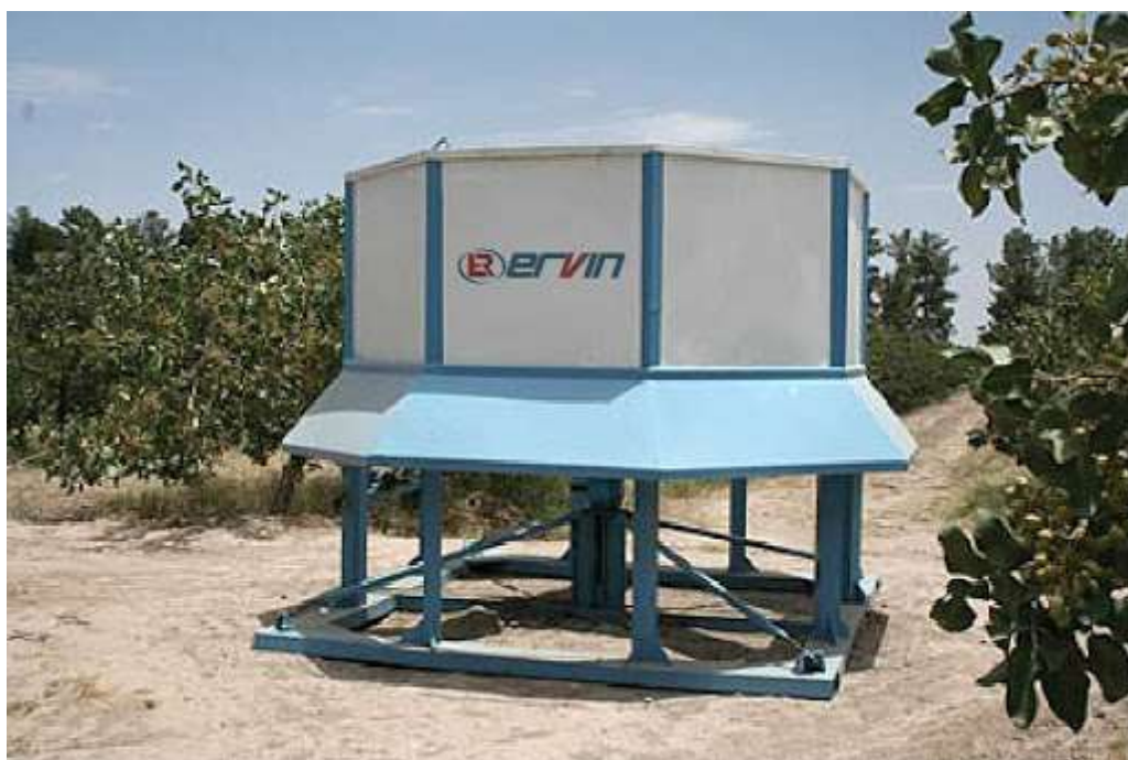
شکل ۵: استفاده از چاهک معکوس برای مقابله با سرمازدگی
