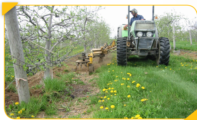
شکل ۷- خاکورز سیلوتیلر مناسب برای خاکورزی زیر سایه‌انداز درخت
