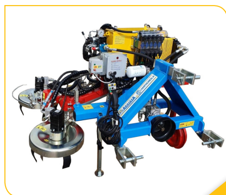
شکل ۵- انواع خاکورز فعال برای خاک‌ورزی زیر سایه‌انداز درخت
