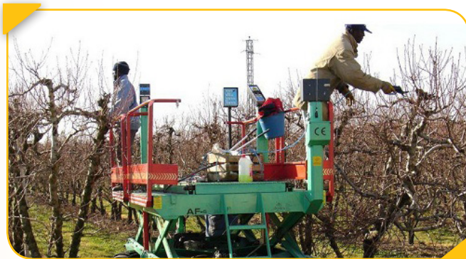
شکل ۲۷- عملیات هرس نیمه مکانیزه به وسیله قیچی‌های دستی و یا قیچی‌های برقی و پنوماتیکی بر روی سکوهای متحرک هرس
