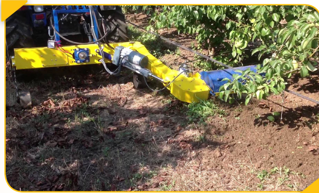
شکل ۴- رتیواتور سنسوردار مخصوص خاک‌ورزی در باغات مختلف، از جمله باغات سیب، ساخت شرکت داخلی
