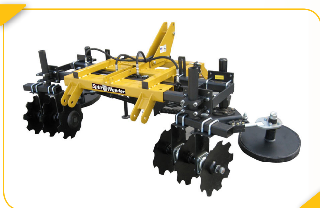
شکل ۱۱- دیسک مناسب برای خاک‌ورزی باغات (دو ردیف درخت)
