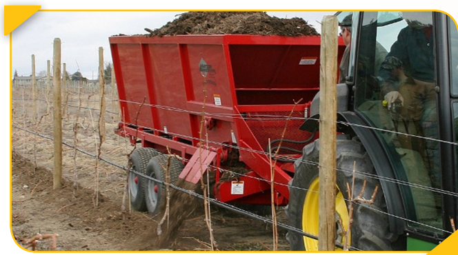
شکل ۴۲- ماشین پخش مالچ و کود گیاهی و دامی در باغات
