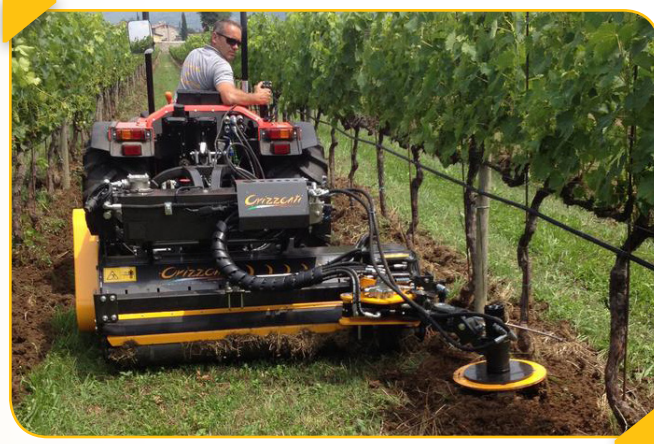
شکل ۳- خاکورز مرکب از رتیواتور و سیکلوتیلر برای خاک‌ورزی زیر سایه‌انداز درخت
