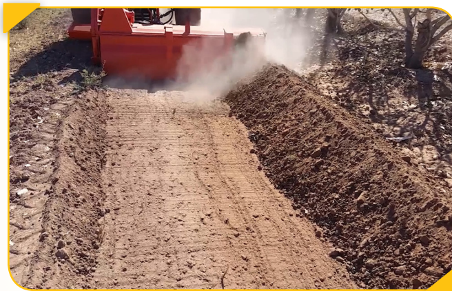
شکل ۱۳- مارپیچ یا رتیواتور انتقال خاک، ساخت شرکت داخلی به منظور استفاده در باغات
