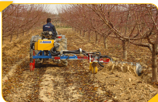
شکل ۱۰- دیسک افست مناسب برای خاک‌ورزی باغات
