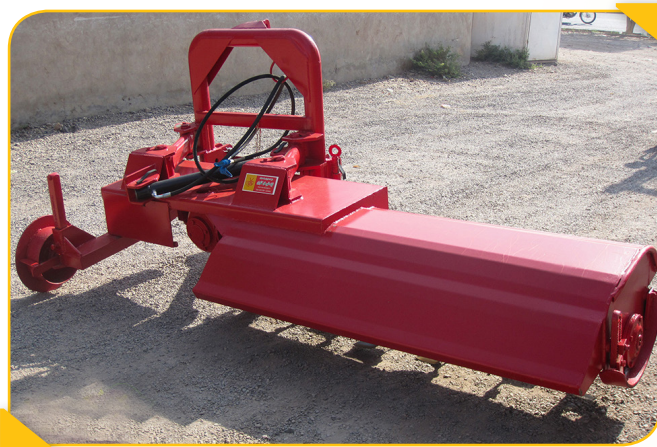
شکل ۲- رتیواتور کشویی ساخت شرکت داخلی مخصوص خاک‌ورزی زیر سایه‌انداز درختان
