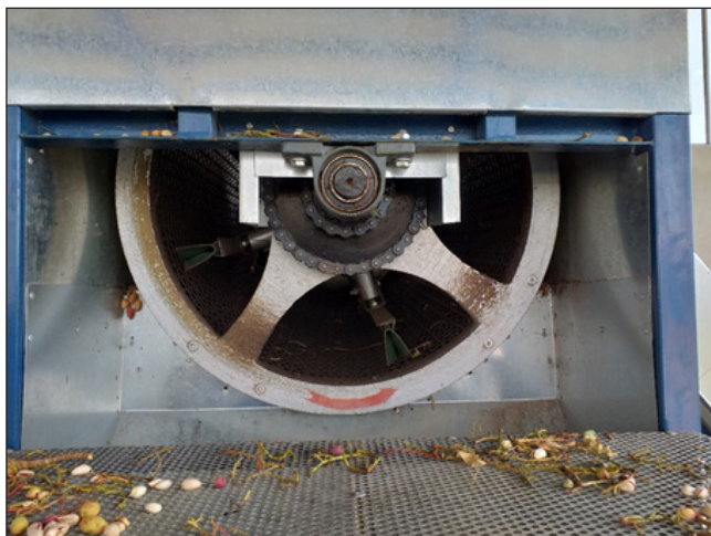
شکل ۷- نمای جانبی استوانه پوست‌کن پیچی
