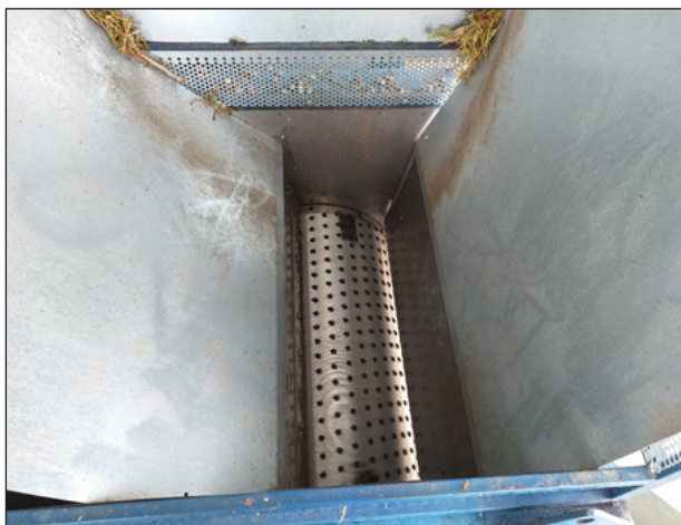
شکل ۸- نمای بالایی استوانه پوست‌کن پیچی
