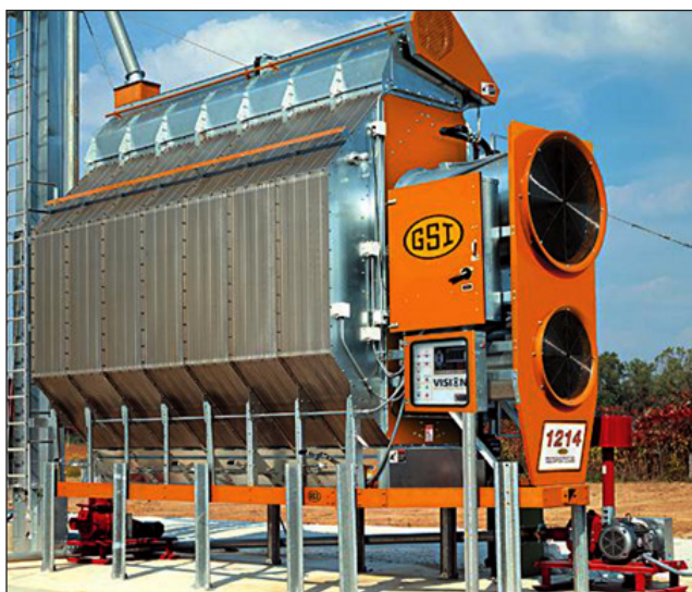
شکل ۲۷- خشک‌کن عمودی پیوسته
