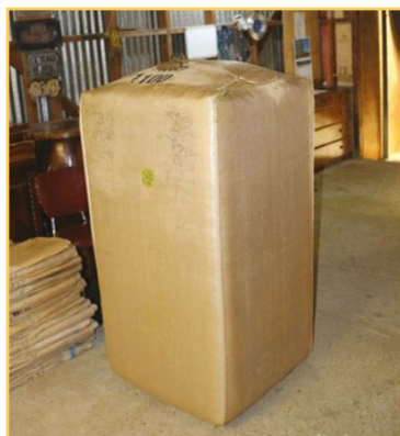
شکل ۳۸. یک نمونه از عدل‌بندی نیوزیلندی که با استفاده از دستگاه تغییر یافته عدل‌بندی پشم بسته‌بندی شده
