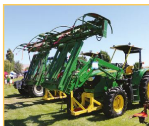
شکل ۲۹. تراکتورها با تیغه‌های قطع کن شاخه‌ها را از سیم‌های داربستی در بالا قطع می‌کنند
