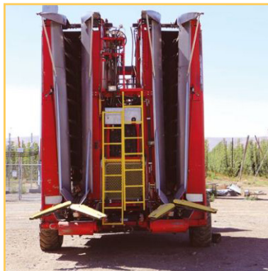
شکل ۲۷. نمای جلوی دستگاه برداشت میوه رازک در آمریکا که در مزارع با داربست ۷ شکل استفاده می‌شود.
