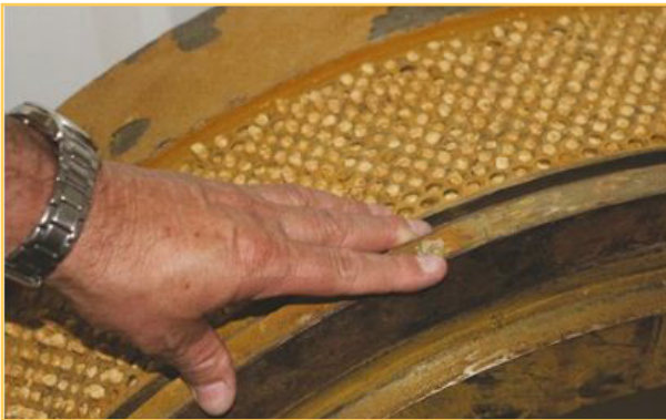
شکل ۴۱. بخش داخلی از یک دستگاه پلیت کننده رازک
