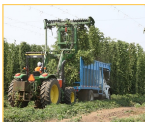
شکل ۲۹. تراکتورها با تیغه‌های قطع کن شاخه‌ها را از سیم‌های داربستی در بالا قطع می‌کنند
