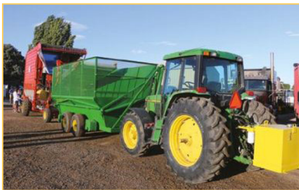
شکل ۲۸. استقرار دستگاهی برداشت رازک شامل برداشت کننده، مخازن حمل و تراکتورهای مربوطه
