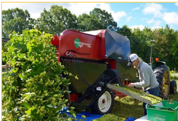
شکل ۳۳. دستگاه HopsHarvester™ ساخت آمریکا که برای مزارع کوچک و متوسط طراحی شده است.
