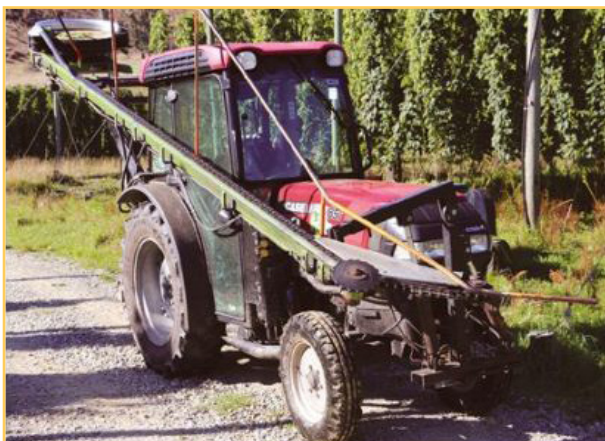
شکل ۳۰. کشنده‌های مخازن حاوی شاخه‌ها برای ماشین‌های قطع کننده مزارع رازک اندازه متوسط
