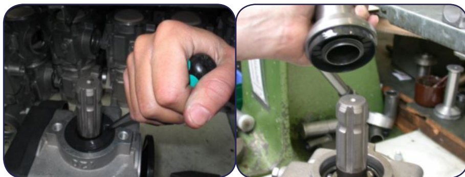
شکل ۳۸. بررسی کاسه نمد پمپ
