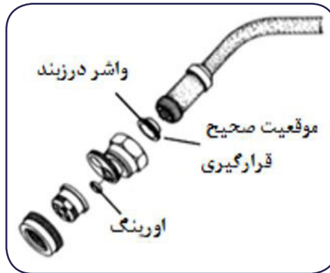
شکل ۲۹. واشر و درزبندهای لوله رابط نازل سمپاش
