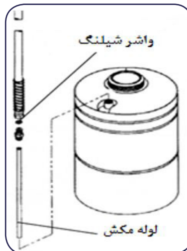
شکل ۳۰. واشر درزبند شیلنگ به مخزن
