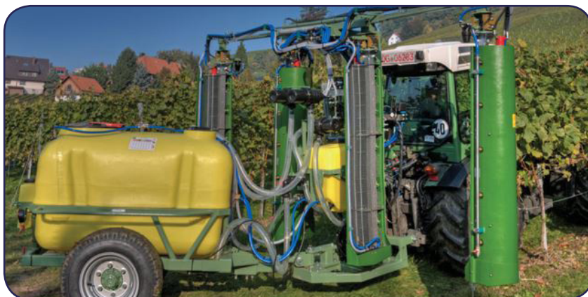
شکل ۲۵. نمونه‌ای از سمپاش مجهز به سیستم بازیافت محلول سم
