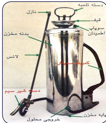
شکل ۵. سمپاش تلمبه‌ای پستی استوانه‌ای ساده
