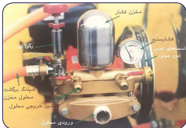
شکل ۱۷. لوله ورودی محلول به پمپ، شیرهای خروجی، فشارسنج، مخزن فشار و رگولاتور
