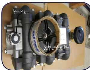
شکل ۳۵. دریچه تخلیه، پیچ تخلیه هوا و محل پر کردن مخزن پمپ
