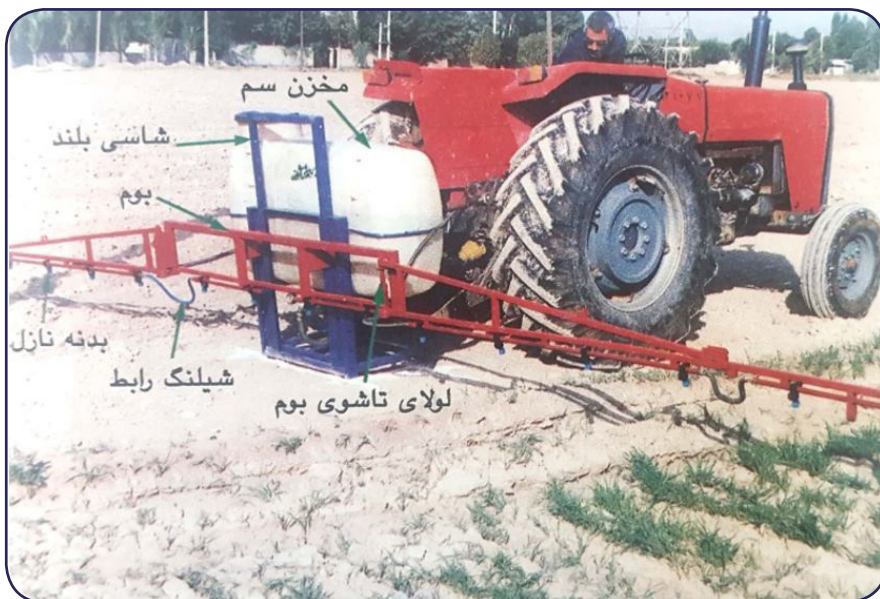
شکل ۱۲. نمای سمپاش پشت تراکتوری بوم‌دار و اجزای آن
