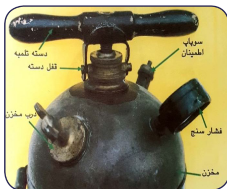
شکل ۶. درب مخزن، سوپاپ اطمینان، فشارسنج، تلمبه و قفل نگهدارنده تلمبه
