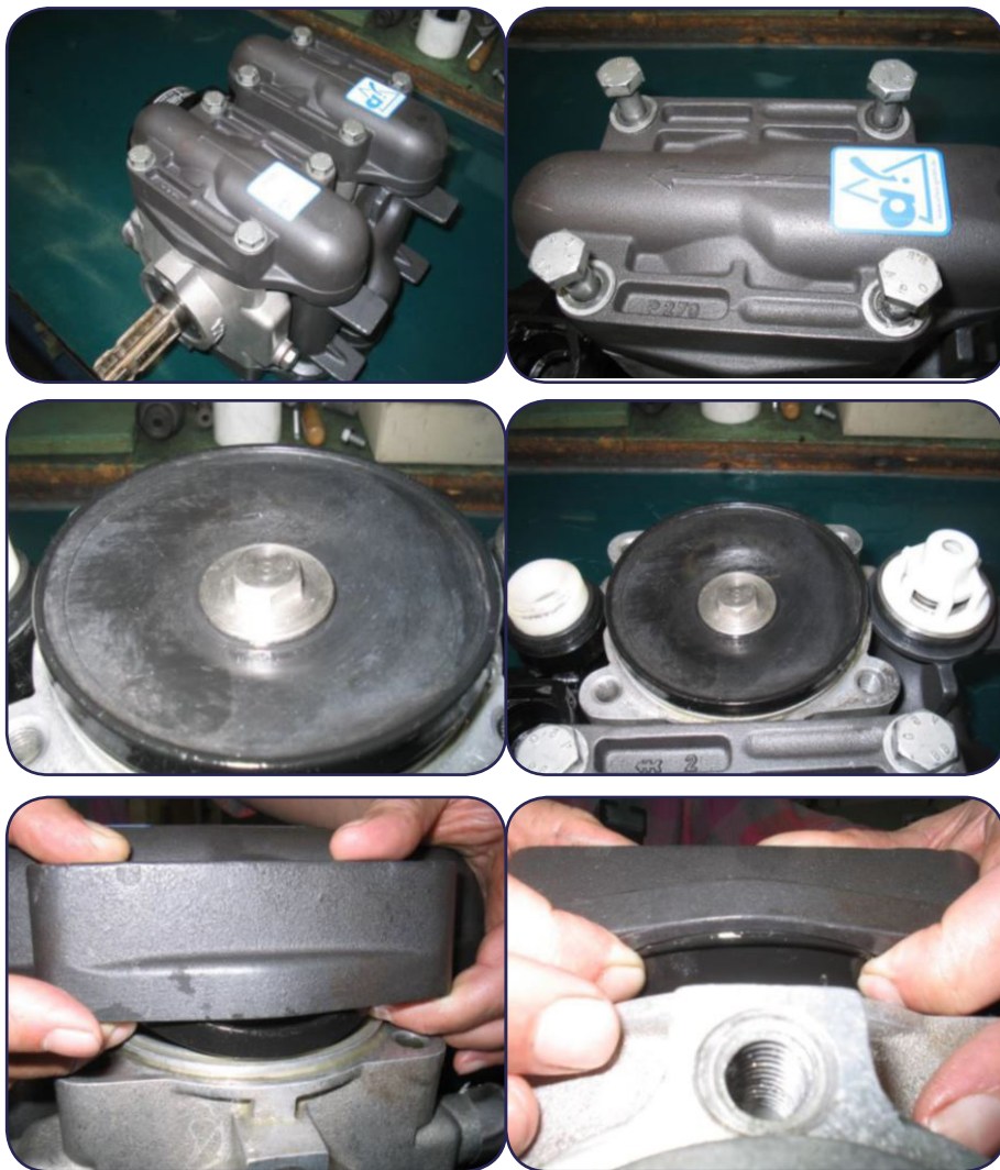
شکل ۳۹. مراحل تعویض دیافراگم
